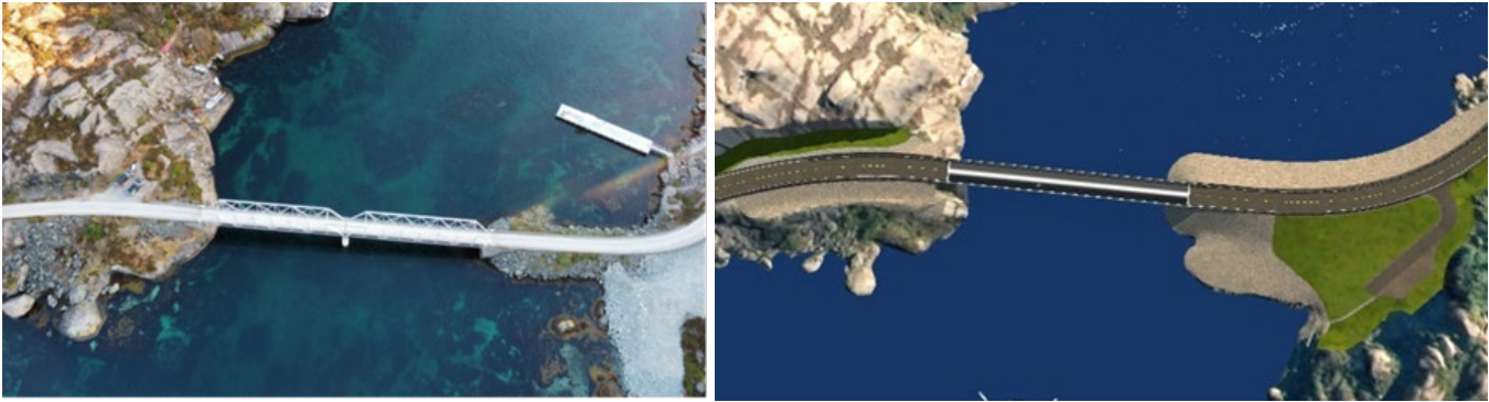
Figur 27:.. Foto av dagens bru sett ovanfrå med nord ned i bilde. Figur 28: Illustrasjon av ny bru sett ovanfrå med nord ned i bildet. Viser hvordan fyllingen på vestsiden blir større enn dagens situasjon. Illustrasjon av Norconsult.
